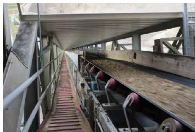
Le convoyeur à bande, vue de dessus
