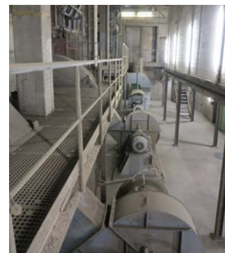
Gauche: Ventilateur d'extraction d'air du four avant la transformation, droite: Série de refroidisseurs de clinker avant la transformation.
