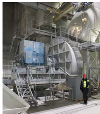
Gauche: Ventilateur d'extraction d'air du four avant la transformation, droite: Série de refroidisseurs de clinker avant la transformation.
