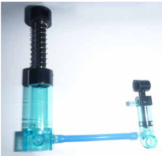
Abbildung 2: Links ist die Druckluftpumpe (Verdichter), rechts ist der Druckluftzylinder (Anwendung). (Foto: Rolf Gloor)
