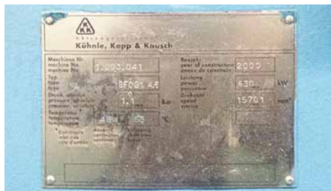
Turbokompressor für Druckluft: Kühnle, Kopp & Kausch, Baujahr 2000, 630 kW, 1,1 bar, 15 701 Umdrehungen pro Minute
