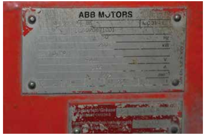
ABB-Motor, Baujahr 1990, 200 kW, 6 Pole mit 995 Umdrehungen pro Minute
