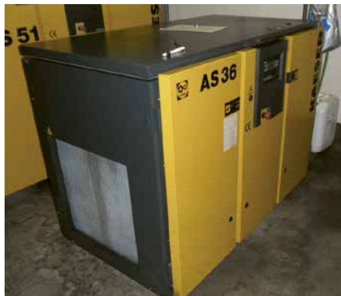
Compresseur d'air à isolation acoustique
