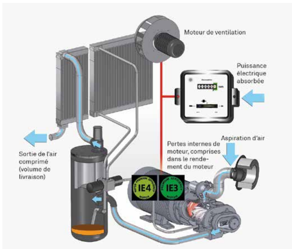
Illustration 12: Structure d'un compresseur à vis - détermination de la puissance spécifique. (Source: Kaeser Kompressoren)
