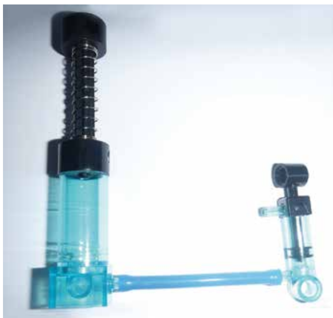
Illustration 2: A gauche, la pompe à air comprimé (compresseur), à droite, le cylindre à air comprimé (utilisation). (Photo: Rolf Gloor)
