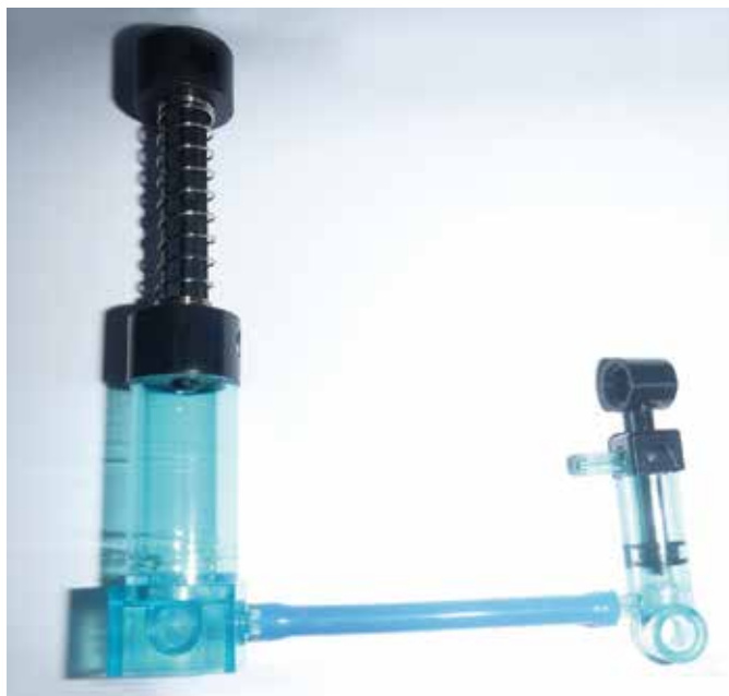
Figura 2: a sinistra c'è la pompa dell'aria compressa (compressore), a destra il cilindro dell'aria compressa (applicazione).
