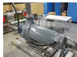
A gauche: L'ancienne pompe avec le moteur à courant continu d'origine, le refroidissement et l'aspiration. A droite: La nouvelle pompe dans son caisson. Photo: Topmotors
