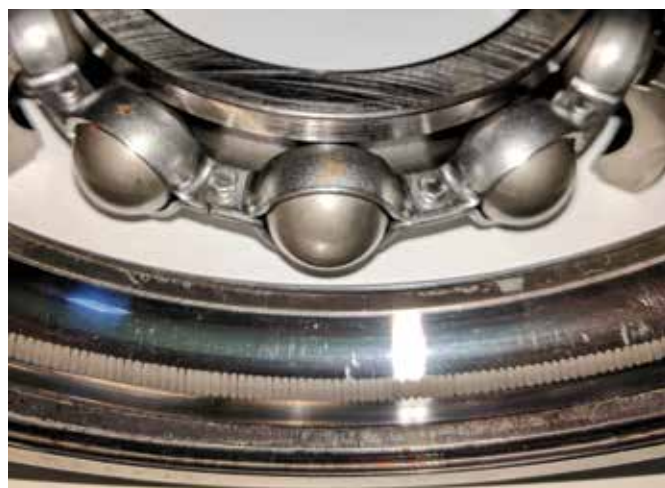
Foto: Increspature dovute alle correnti nei cuscinetti (Fonte: Dottoressa Hanna Putzi-Plesko, ZHAW School of Engineering)
