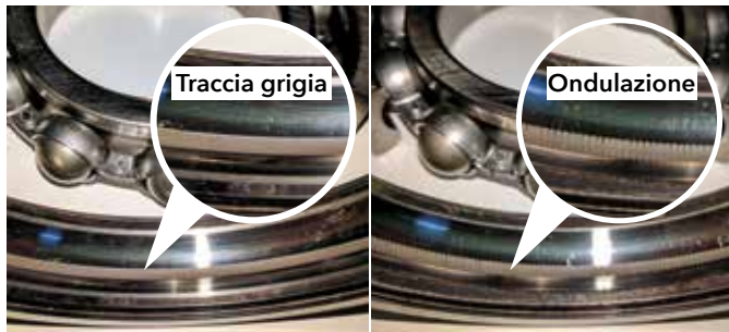
Figura 1: I due tipici modelli di danno causati dalle correnti dei cuscinetti; a sinistra: traccia grigia, a destra: formazione di ondulazioni.
